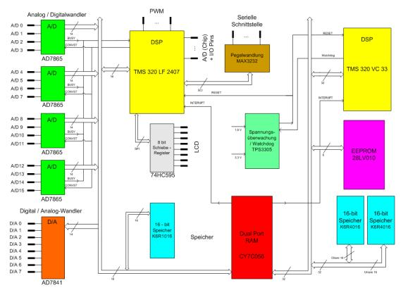
Abb. 1: Konzept des Dual-Processor-Boards
