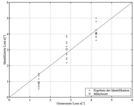
Bild 6: Simulierte Alterung des Walzenantriebsstranges durch Realisierung unterschiedlicher Loseweiten am Prüfstand (g= 1,44/, g= 2,8/, und g=4,24/). Neben den identifizierten Losewerten (+) sind die Mittelwerte (o) über 10 Optimierungsläufe dargestellt.
