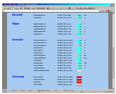
Bild 2: Tabellarische Darstellung der Prozeßvariablen eines BHKW
