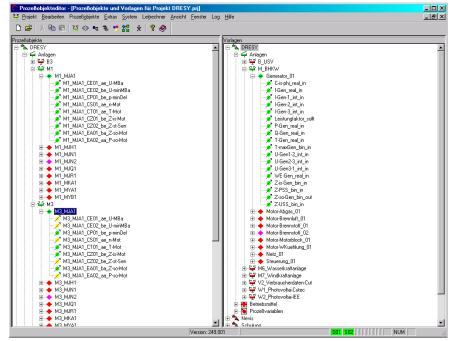
Bild 1: Datenmodell für ein typisches BHKW
