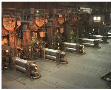
Bild 1: Teil der Fertigstraße einer Warmbreitbandwalzanlage, bestehend aus sieben kontinuierlich angeordneten Quartogerüsten
