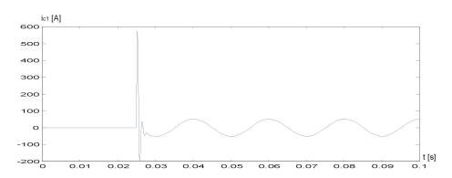
Bild 2: Einschaltstrom des RC-Filters beim Parallelbetrieb ohne Vorwiderstand (Simulation)
