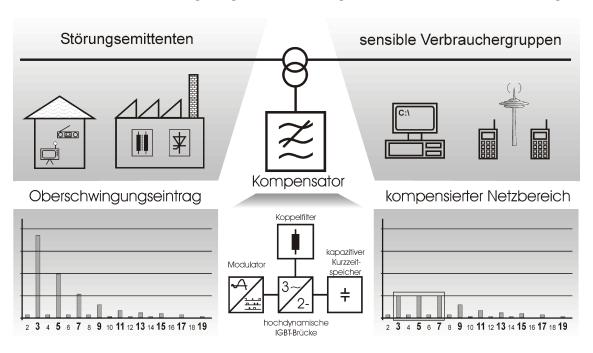
Aufbau und typischer Einsatzbereich der Kompensationseinrichtung
