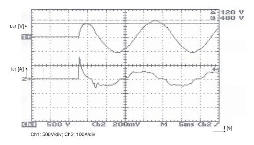
Bild 4: Einschaltspannung und -strom des RC-Filters beim Parallelbetrieb mit Vorwiderstand (Messung)
