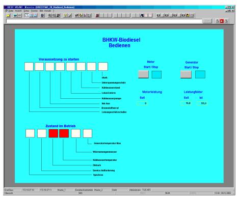
Bild 3: Bedienfenster für das Biodiesel-BHKW
