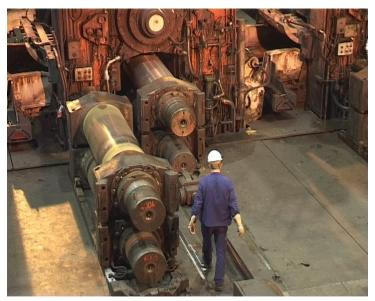
Bild 2: Wechsel des Arbeitswalzenpaares eines Quartogerüstes
