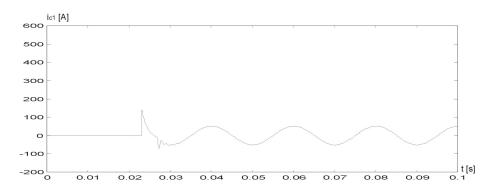
Bild 3 Einschaltstrom des RC-Filters beim Parallelbetrieb mit Vorwiderstand,  $R_1 = 1,5\Omega(Simulation)$
