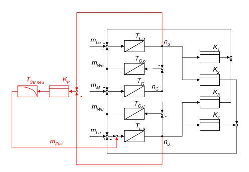
Bild 2: Striktur des Regelung des zusätzlichen Antriebs
