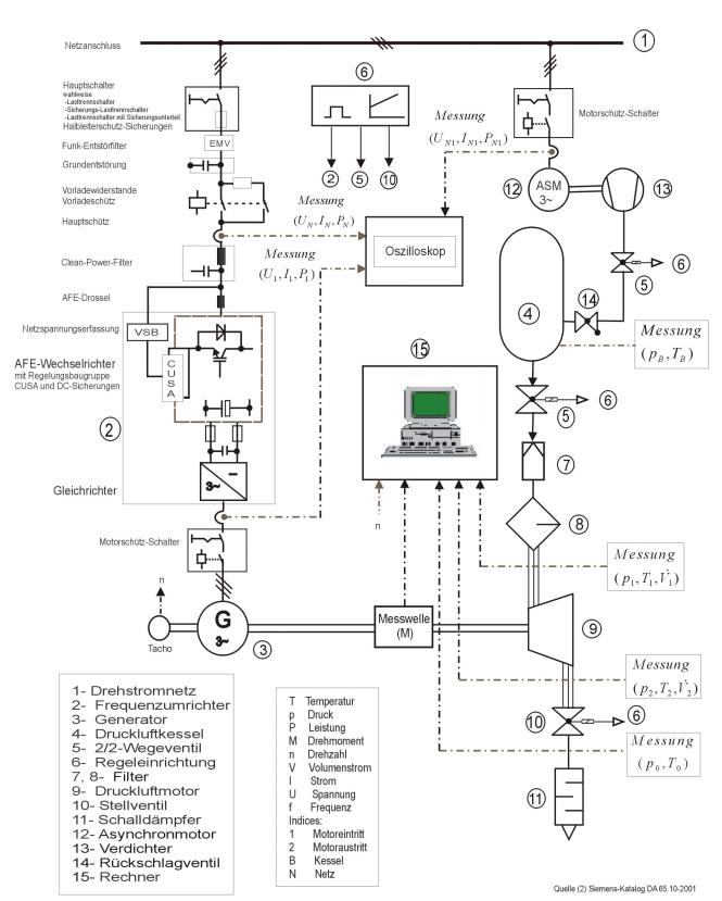
Schaltschema für das Energiespeichersystem mit ungekühlter Druckluft
