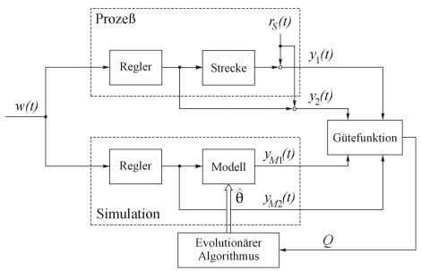
Bild 5: Blockschaltbild der Parameterschätzung mit evolutionären Algorithmen
