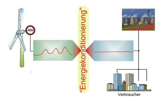
Prinzip der Energiekonditionierung
