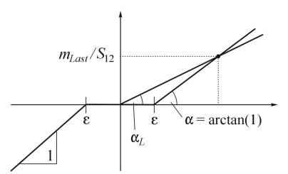
Bild 4: Linearisierung der Losekennlinie durch eine Grade
