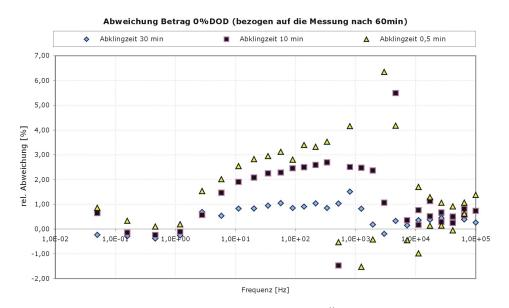
Bild 1: Relative Fehler der Impedanzmessung. Änderung des Betrags der Ortskurve im Bode-Diagramm bei unterschiedlichen Zeiten nach Entladung (Entladetiefe (DOD) = 0%); Die Änderungen sind auf die Werte der Ortskurve nach 60 Minuten Abklingzeit bezogen.
