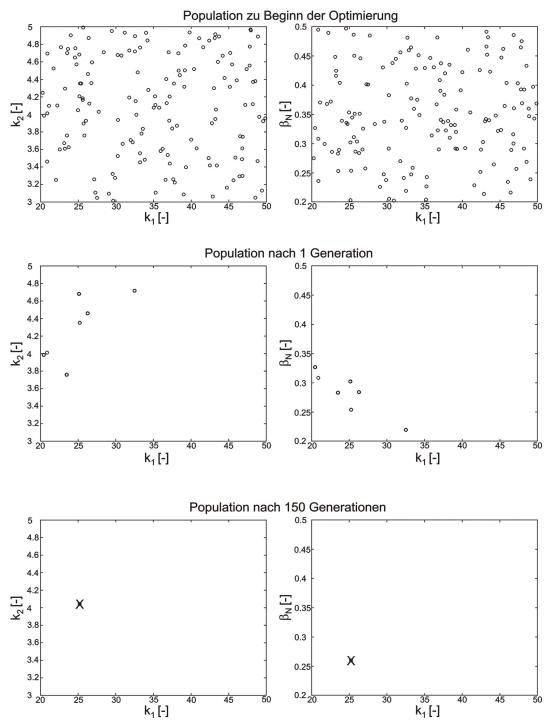
Bild 2: Anfangspopulation und Verteilung der Population nach 1 bzw 150 Generationen während eines Optimierungslaufes (X) - bester Parametervektor
