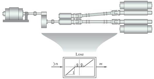
Schematische Darstellung des Antriebssystems eines Gerüstes mit Kammwalzgetriebe
