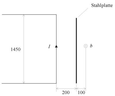
Bild 1: Die Messanordnung besteht aus einem Leitersystem und einer Schirmplatte aus Stahl. Das Leitersystem ist aus einem zu- und abführenden und einem senkrechten Leiter aufgebaut. Die 1 m breite Schirmplatte ist in einem Abstand von 0,2 m mittig zum senkrechten Leiter angebracht. Die Messungen werden auf einer Messgeraden b 0,1 m vor der Schirmplatte durchgeführt.
