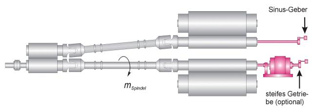
Bild 1: Integration eines zusätzlichen Antriebs zur aktiven Schwingungsdämpfung
