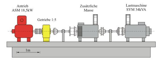
**Bild 7:** Prüfstand zur Erprobung des Konzeptes. Durch Entfernen des Getriebes sind unterschiedliche Massenverhältnisse realisierbar. Mit einer zusätzlichen modifizierten Kupplung wurden unterschiedliche Loseweiten realisiert.
