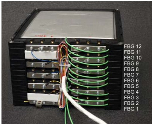
Abbildung 1: Teil einer Fahrzeugbatterie mit faseroptischer Sensorik (grün)
