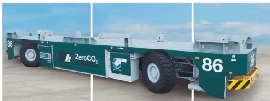
Abbildung 1: Schwerlastfahrzeug (AGV) für den Containertransport im Hamburger Hafen mit batterie-elektrischem Antrieb (Quelle: TEREX, HHLA/CTA)
