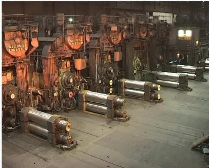
Bild 1: Teil der Fertigstraße einer Warmbreitbandwalzanlage, bestehend aus sieben kontinuierlich angeordneten Quartoerüsten
