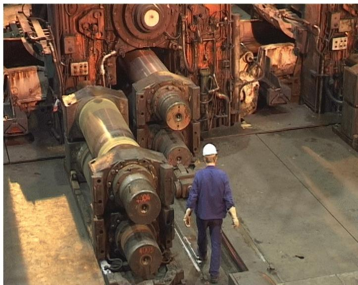
Bild 2: Wechsel des Arbeitswalzenpaares eines Quartoerüstes
