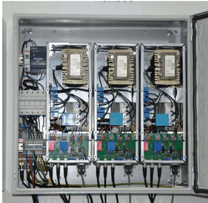
Bild 2: VISMA-Wechselrichter
