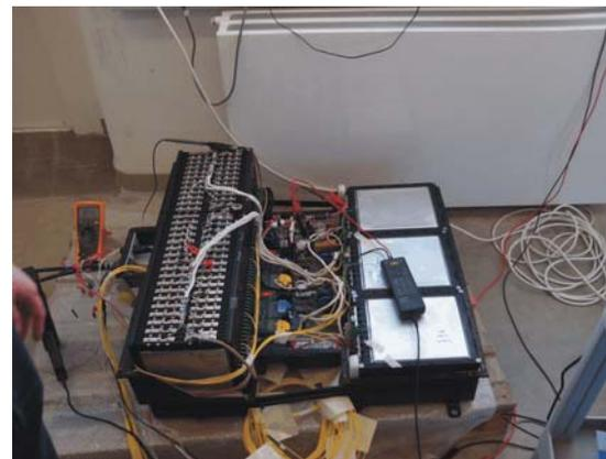
Abbildung 2: Komplette Fahrzeugbatterie mit Temperatursensoren und weiterer Messtechnik
