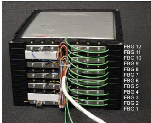
Abbildung 1: Teil einer Fahrzeugbatterie mit faseroptischer Sensorik (grün)
