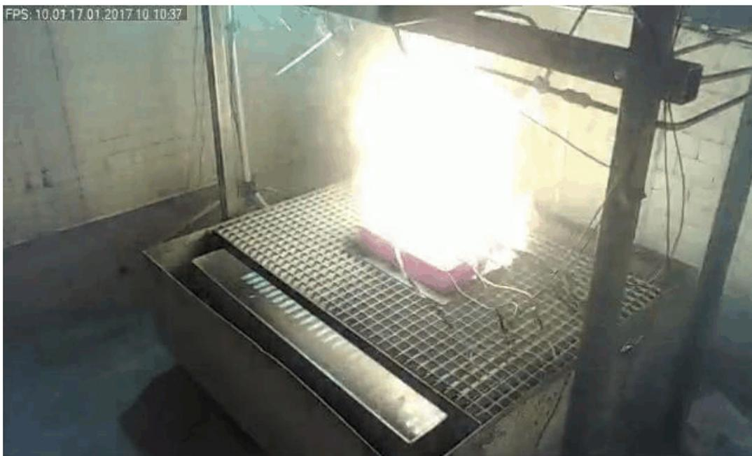
Gemeinsam mit der Firma FNL Neuruppin und den Forschern der TU Clausthal werden experimentelle Nachweise der Löschwirkung verschiedener Löschmittel bei Bränden von Lithium-Ionen-Batterien erbracht. Am Batterie-Sicherheitscampus Deutschland können neuartige Konzepte zur Vorbeugung von Batteriebränden entwickelt sowie die Wirksamkeit von Löschmitteln für unterschiedliche Speichertechnologien erforscht werden.
