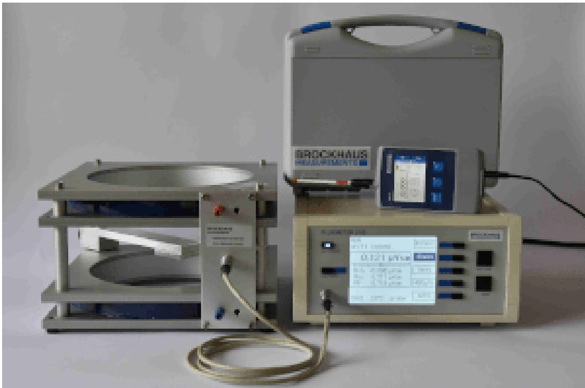
Abbildung 1: Messplatz zur Messung der magnetischen Leitfähigkeit, bestehend aus Gaußmeter, Flussmeter und Helmholtz-Spule.
